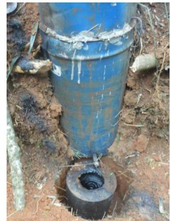
Figure 3. Meule casamançaise. (A) meule en phase de carbonisation ; (B) recueil du liquide pyroligneux. Photo NDJIKI
